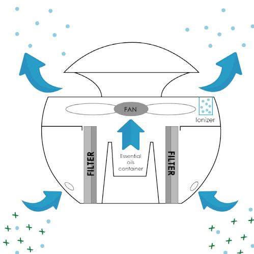
Urządzenie przy pomocy wentylatora zaciąga powietrze z pomieszczenia. Następnie powietrze jest oczyszczane za pomocą filtra E11 zatrzymującego zanieczyszczenia, bakterie i małe cząstki kurzu.
