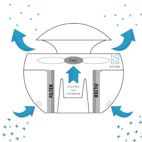
El ventilador aspira el aire por las aperturas situadas debajo del aparato. El aire es purificado gracias a un filtro de partículas de tipo E11 que retienen el polen, las bacterias y pequeñas partículas.
